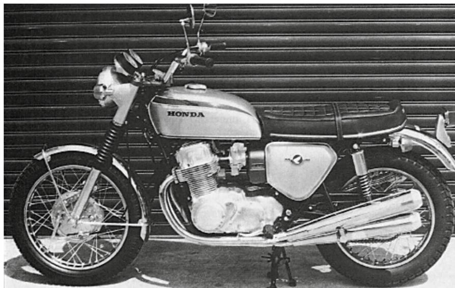
So nie realisiert: CB 750-Prototyp mit zum Fahrer gerückten Lenker und Trommelbremsen.
