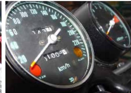
Früherkennung: Die Rundinstrumente der K0 hatten die Kontrolllampen noch im Zifferblatt.
